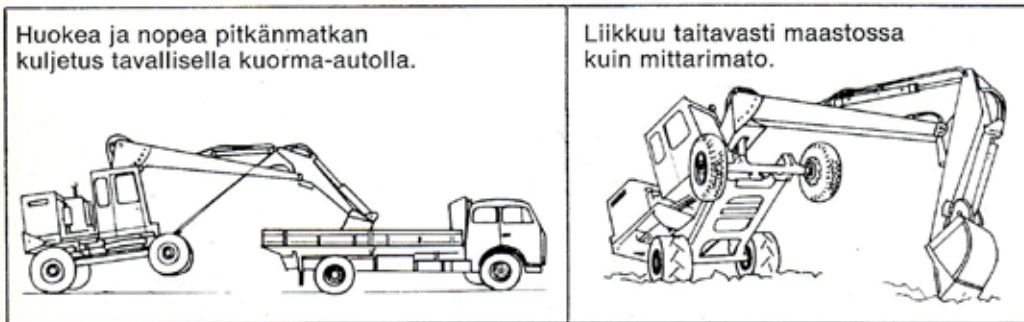
Brøytin myyntiesite havainnollisti koneen maantiesiirron ja liikuttelun menetelmiä tällä kuvalla.
