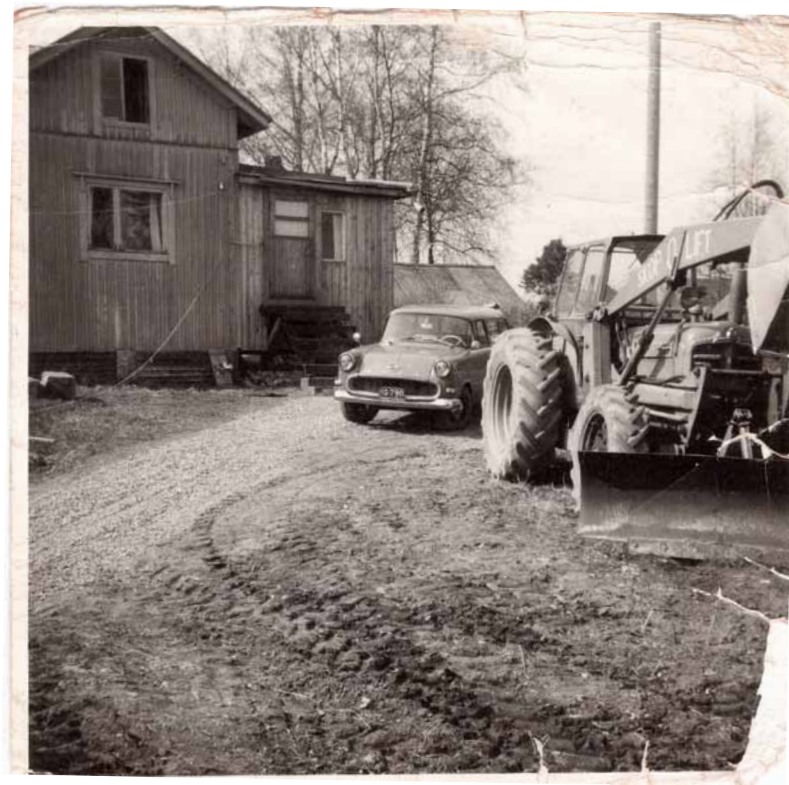
Kuva firman alkuvuosilta. Takana on kotitalo ja sen edessä maansiirtoliikkeen koko tuon aikainen kalusto. Opel Rekord -farmariautolla taittuivat työmatkat ja Fordson Super Major Manuelilla tehtiin työt. Traktori oli jo tässä vaiheessa varustettu sekä puskulevyllä että Skop-O-Lift -etukuormaajalla. Talon päädyn iso ikkuna kuului ainoalle asuinkäytössä olleelle huoneelle. Maantien puolella olevat kaksi muuta huonetta olivat kauppa liikkeen tiloina. Talon sivussa ollut eteinen taas oli kaupan varastotilana. Auton takana hämöttää maakellarin katto.
